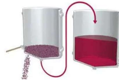
Étape 5 - **L'écoulage** ou **le décuage** : Le vin (vin de goutte) est écoulé par gravité dans une autre cuve.
